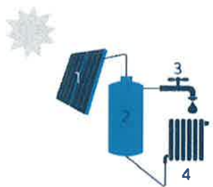
1. Zonnecollector | 2. Opslagvat zonneboiler | 3. Sanitair warm water (of afgifteenheid voor ruimteverwarming, optioneel)
