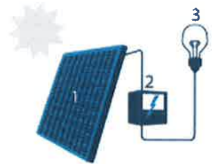
1. Zonnepaneel | 2. Omvormer | 3. Elektrisch toestel
